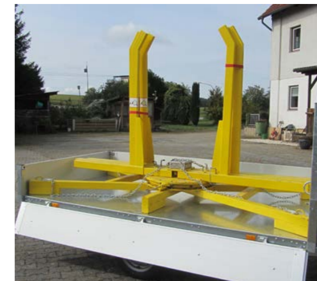
4 Abwickelvorrichtung zum Transport vorbereitet
