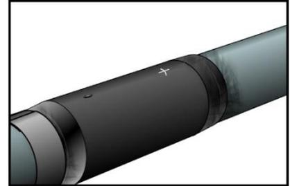
Die Manschette erst unmittelbar vor der Verarbeitung auspacken und Schutzfolie abziehen (Verschmutzungsgefahr). Anhand der Zentriermarken das abgeschrägte Manschettenende positionieren und um das Rohr legen. Hier auf die richtige Position (Markierung auf der Manschette) achten.
