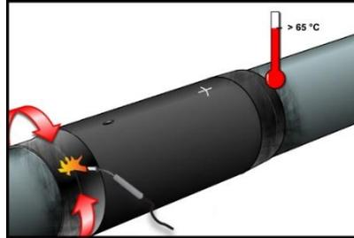
Die Dichtflächen sind mit einer weichen Propangasflamme auf 65°-70°C durchzuwärmen. Temperatur kontrollieren.
